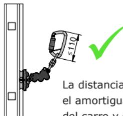
La distancia máxima entre el amortiguador de caídas del carro y el amarre frontal del arnés puede ser de máximo 11 cm (= 1 longitud de mosquetón).
