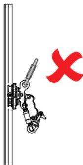
La distanza massima tra ammortizzatore di caduta della guida scorrevole e il punto di ancoraggio anteriore dell'imbragatura anticaduta deve essere di max. 17 cm (= 1 lunghezza del moschettone).
