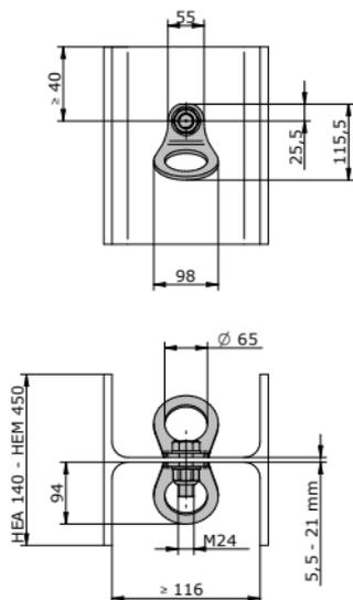
Grundvoraussetzung für eine fach-/sachgerechte Montage ist die Verwendung der originalen, in dieser Gebrauchsanleitung angeführten Befestigungsmittel.
