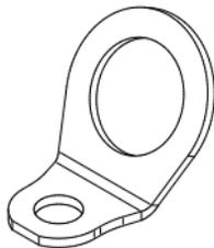
**A) Gebrauchsanleitung****B) Schmiermittel:** Weicon AntiSeize ASW 10000**C) 2x Beilagscheibe M24:** Edelstahl AISI 316**D) 2x Anschlagöse:** Edelstahl AISI 316**E) Sicherungsmutter M24:** Edelstahl AISI 316**F) Sechskantschraube M24 x 70:** Edelstahl AISI 316
