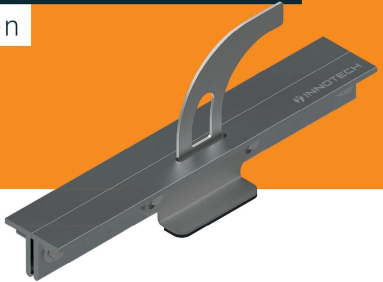
Der Sicherheitsdachhaken SDH-INDUSTRY-31 von INNOTECH ist die nächste logische Option für Stehfalzdachsysteme. Eine besondere Konstruktion des Edelstahlbügels sorgt für eine Schonung der Oberfläche. Die Montage erfolgt dachdurchdringungsfrei und verhindert so das Eintreten
