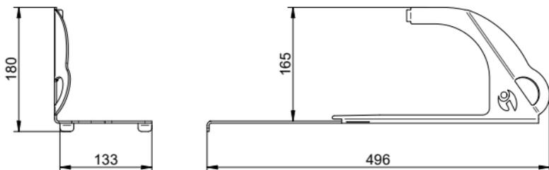
"SDH-02" ist ein Sicherheitsdachhaken, welcher auf einem statisch geprüften Untergrund (z.B. tragende Dachkonstruktion) montiert wird.
