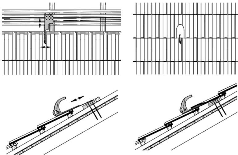
Die Abdichtung der Dacheindeckung erfolgt mit Eindeckblechen, fachgerecht nach den einschlägigen Normen. Bei geringen Dachneigungen sind zusätzliche Maßnahmen (Dichtstreifen – etc.,...) notwendig.
