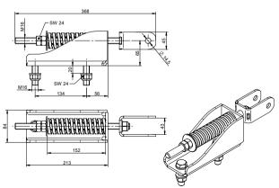
**Chariot IND-GLEIT-10:** acier inoxydable AISI 316 amovible et compatible avec les courbes
