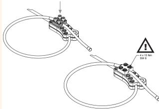
Attacher le cadenas d'extrémité sur le système IND-EB-40 avec le boulon et la goupille.
