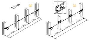
C) Systèmes de câbles plus longs avec support intermédiaire fixé, compressé des deux côtés tous les 15 m Distance du système recommandée : 300 m max.
