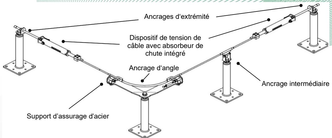
Fig. 1: Exemple d'application du dispositif d'ancrage, type: ALLinONE
